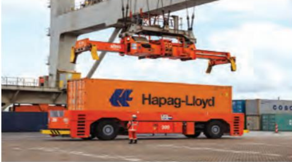
3 .Konteyner kavrayıcı ve otomatik kılavuzlu araç
