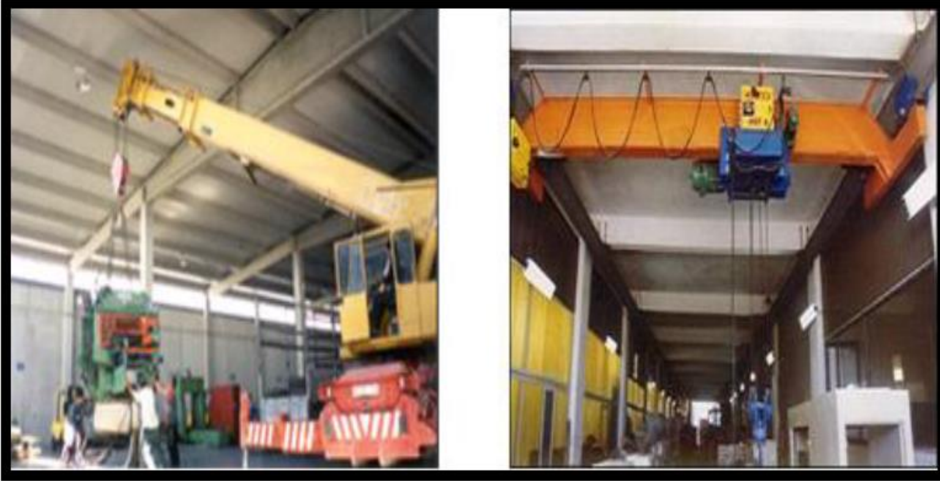
Resim 4.27: Teleskopik ve askılı gezer köprülü vinç
